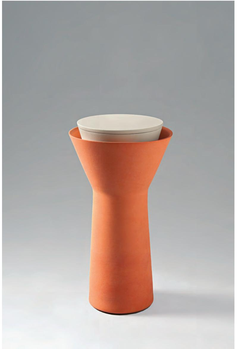
**Filtracotta** Je me suis intéressée au système ancestral de réfrigération de l'eau par évaporation au travers de la terre cuite. En alliant ce principe aux technologies actuelles de filtration de l'eau potable, j'obtiens une nouvelle typologie de carafe filtrante. Un entonnoir en bi-injection plastique et silicone vient se positionner dans le pot en terre cuite, tout en laissant passer l'eau purifiée.
